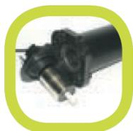
Современный асинхронный двигатель насоса ECO обеспечивает оптимальную производительность благодаря тщательно сбалансированному электромагнитному полю; при этом вращаемое двигателем лопастное колесо является коррозионно стойким. Керамический вал и керамические подшипники используются как подшипники скольжения.
