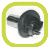
Высокопроизводительное лопастное колесо Vortex насоса ECO обеспечивает оптимальную эффективность и исключительно низкое энергопотребление. Лопастное колесо изготовлено из нержавеющей стали, латуни, пластика и монтируется на керамическом валу с керамическими подшипниками повышенной прочности.
