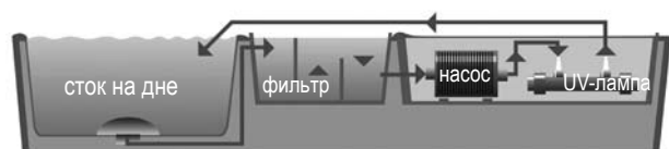
Эксплуатация посредством естественной ( гравитационной ) циркуляции
