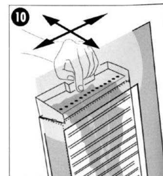
5. После времени, необходимого для адаптации прибора к условиям работы, текущая вода все равно неравномерно распределяется по поверхности.
