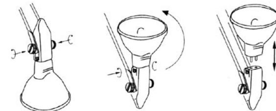
Теперь Вам необходимо немного раскрутить винты на крепежном фиксирующем элементе и заменить старую галогеновую лампочку на новую (GU 5/3 12 В / 20 Вт). Сейчас Вам нужно снова закрутить маленькие винты. Удостоверьтесь в том, что лампочка хорошо зафиксирована в соответствующих пазах. После этого Вы снова можете настроить освещение под желаемым углом и только затем плотно закрутить винты.
