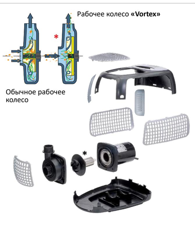
\*Свободновихревое рабочее колесо «Vortex»: частицы грязи до 8 мм, которые содержатся в воде, могут свободно протекать через рабочее колесо «Vortex».
