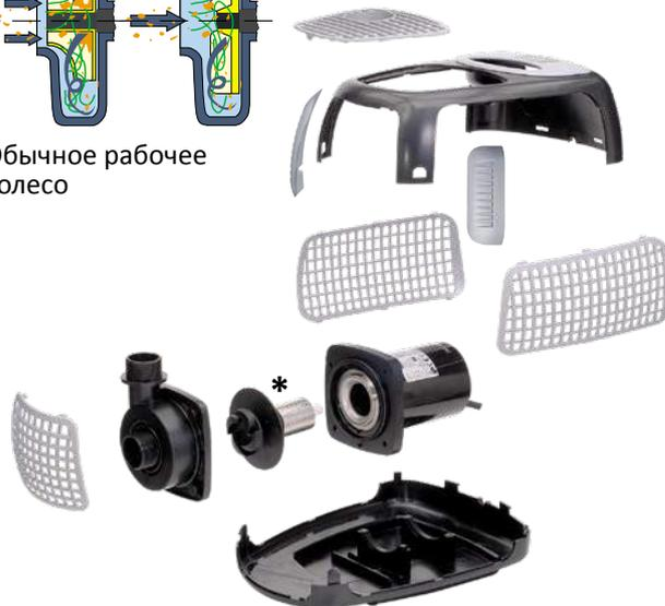
\*Свободновихревое рабочее колесо «Vortex»: частицы грязи до 8 мм, которые содержатся в воде, могут свободно протекать через рабочее колесо «Vortex».
