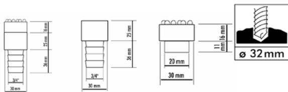
рекомендуемый диаметр отверстия источника в камне
