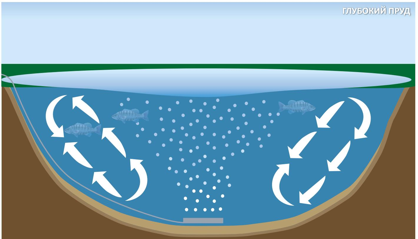
По мере выхода из диффузора воздух поднимается до поверхности пруда в форме латинской буквы V, создавая воздушный поток. Чем выше этот поток может подняться, тем шире он становится, и тем больший объем воды он способен охватить.
