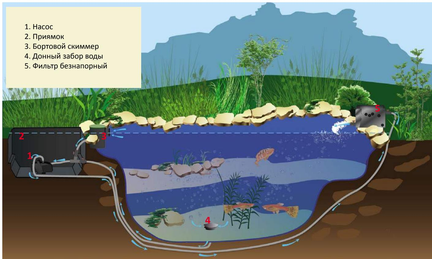
**Гравитационная схема подключения безнапорной системы фильтрации (вид в разрезе)**
