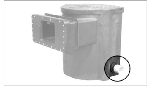
Боковое нижнее отверстие предусмотрено как для подключения всасывающей линии погруженного в водоем насоса, так и выносного «сухого», расположенного ниже уровня воды. С помощью фрезы вырезается отверстие для подключения шланга Ø 63 мм.
