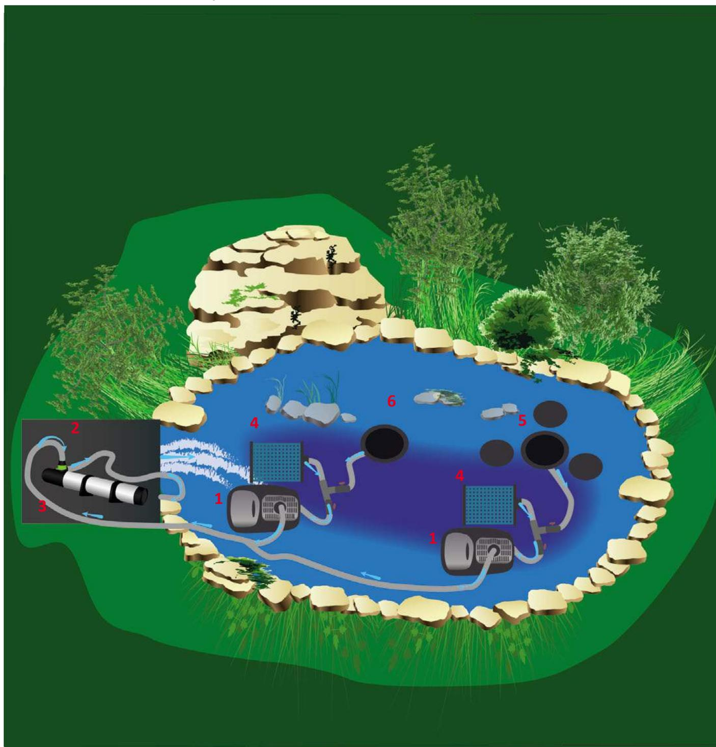
**Схема подключения безнапорной системы фильтрации под давлением насоса (вид в разрезе)**
