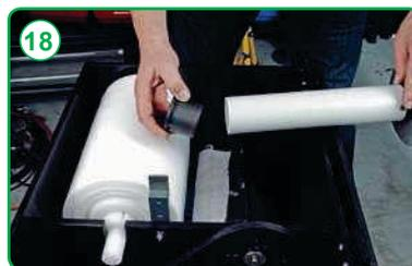
...есть паз в намоточном барабане, а в заглушку вкручен винт с шестигранной головкой.
