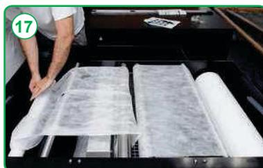
... Теперь ослабьте фиксатор намоточного барабана, отодвинув его в сторону от...
