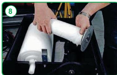
... После этого можно выдвинуть и извлечь ролик из фиксатора.
