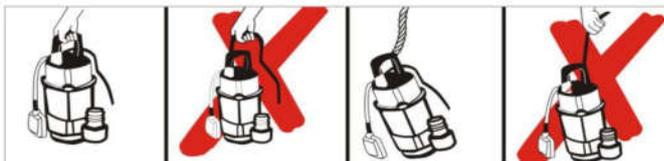
При установке, подъеме или перемещении насоса держитесь только за ручку для переноски. Если необходимо опустить или поднять насос, можно присоединить подходящий опускной трос к ручке для переноски. Категорически запрещается использовать напорный шланг, сетевой кабель или кабель поплавкового выключателя для установки, подъема или переноски насоса.
