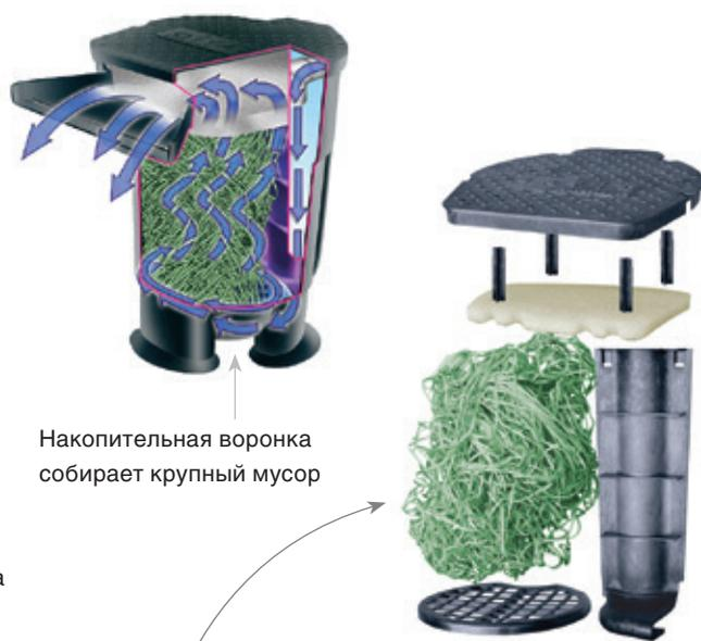
Фильтр использует естественную динамику воды. Тщательно разработанная цилиндрическая форма фильтра приведет прудовую воду в медленное круговое движение. В ходе этого процесса крупный мусор будет удален до того как вода попадет в фильтрующую среду, а вода пройдет равномерно через всю камеру фильтра. При использовании волокна Springflow Вы получите фильтр, который работает почти в три раза эффективнее, чем обычный камерный фильтр!
