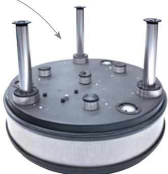
Готовая фонтанная установка с автоматической сменой водных картин за счет последовательного переключения встроенного гидравлического клапана. Бесступенчатое регулирование продолжительности действия каждой из водных картин, простые регулировки для установки высоты каждого фонтана. Имеется встроенная подводная подсветка с четырьмя светофильтрами разных цветов. Устанавливается в любую подходящую емкость и начинает работать сразу же после включения в электрическую сеть.
