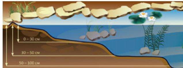
Для каждой зоны существует свой тип растений: *болотную зону (0–30 см)*, и *мелководную (30–50 см)* как правило засаживают прибрежными растениями, *глубоководная зона (50–100 см)* предназначена для посадки погруженных растений (оксигенаторов) а также плавающих. Рекомендуется соблюдать уклон не более 45°. Следует всегда снимать на 5–10 см сверх предусмотренной глубины пруда, так как под пленку следует еще уложить слой песка и защитный нетканый материал (геотекстиль).
