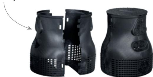
Предназначена для накопления воды в альпийском ручье. Состоит из двух вертикальных сегментов и крышки. В корпусе предусмотрено отверстия для вывода шланга или трубы при установке насоса внутри шахты. Высота шахты с крышкой 56 см, диаметр 38/61 см. Расход 60 000 л/ч.
