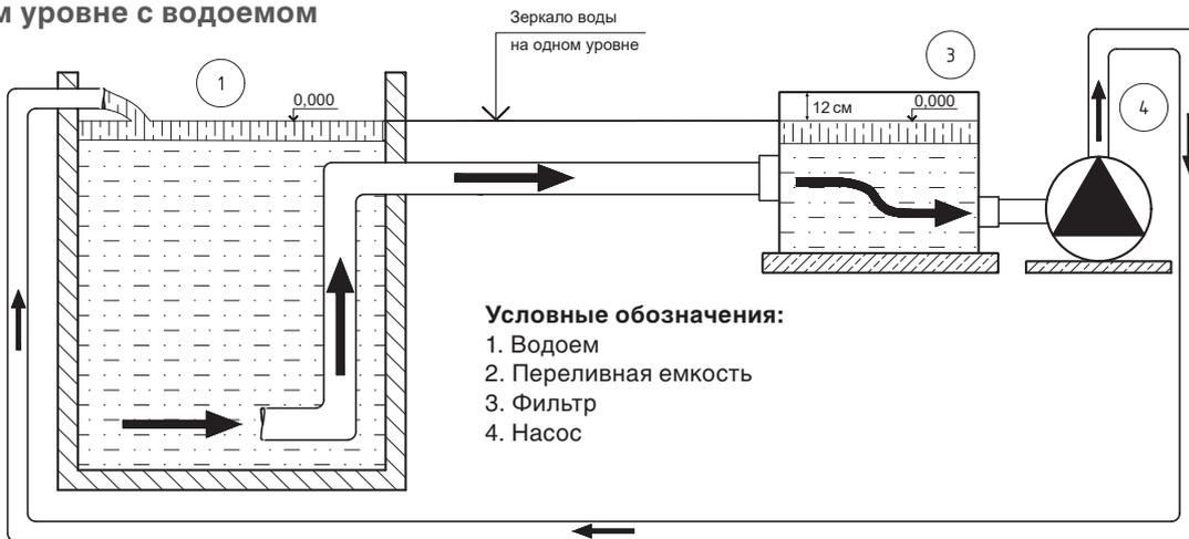
Переливная схема подключения системы фильтрации при расположении фильтра ниже уровня воды водоема
