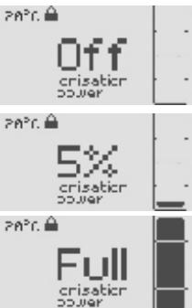
et de l'augmenter progressivement (au lieu de commencer par un réglage maximum et de le diminuer progressivement). ***Une fois les algues disparues du bassin, on peut ramener le taux d'activation de l'appareil à 5 % afin de maintenir une action algistatique préventive dans le bassin.*** Pour réduire ces dépôts sur l'anode (1) et la cathode (2), la polarité est souvent inversée. Pendant l'inversion de polarité, le LED placé sur le couvercle à vis s'allume alternativement rouge et vert.
