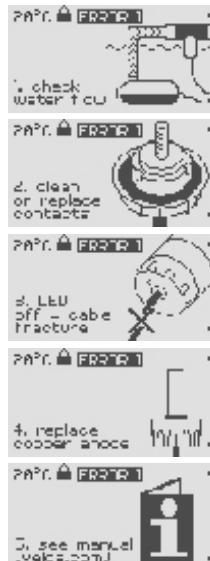
Wanneer de melding **ERROR 2** (knipperend) op het display verschijnt en de LED op de eindkap rood of groen knippert, kan dit verschillende oorzaken hebben. Stap voor stap kan het probleem worden verholpen.
